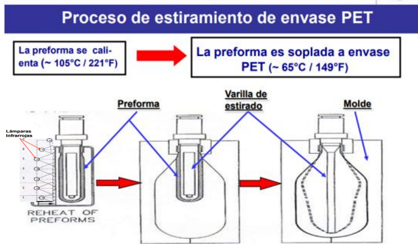
Ilustración 11. Diagrama de proceso de soplado.
