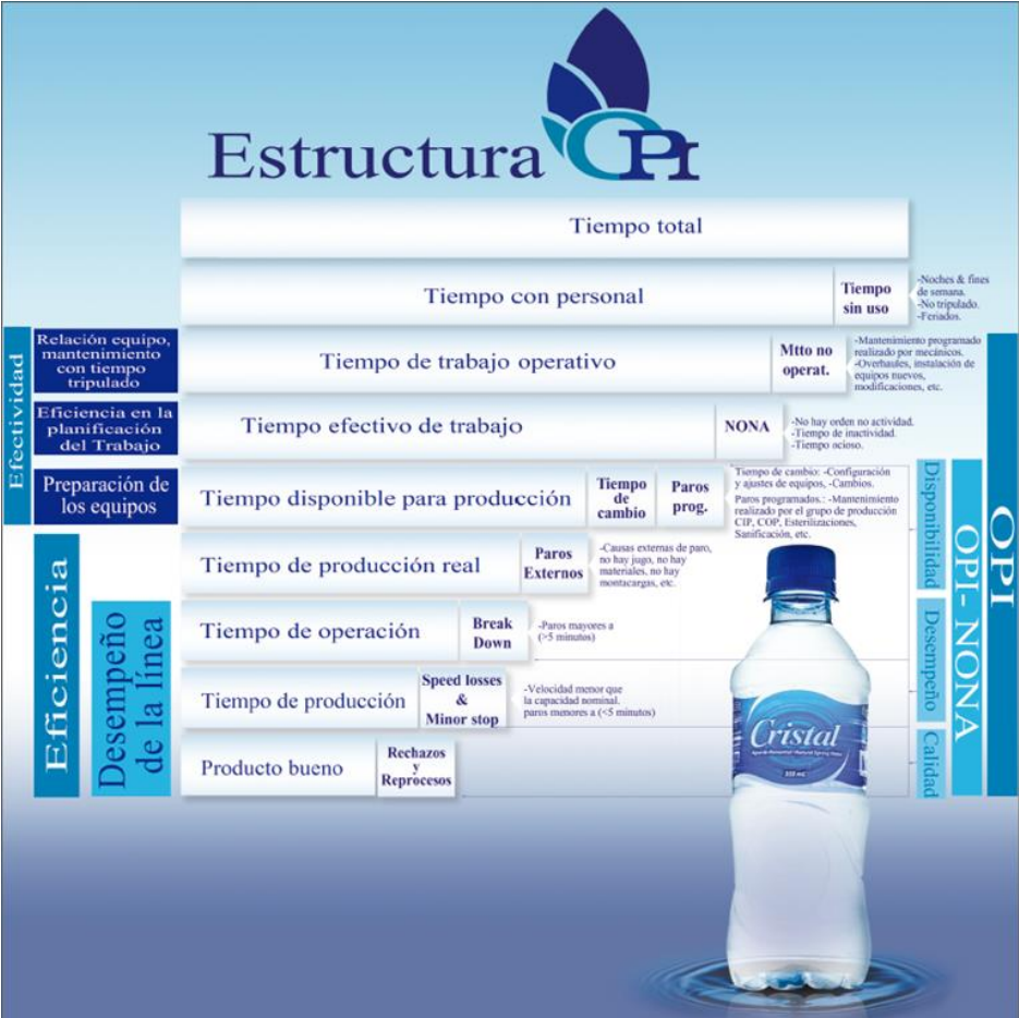
Ilustración 26. Estructura de clasificación de indicadores de eficiencia.
