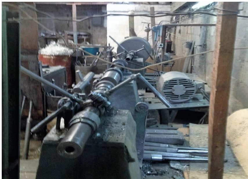
Imagen N° 4. Torno de repujado (Máquina para la elaboración de productos)
