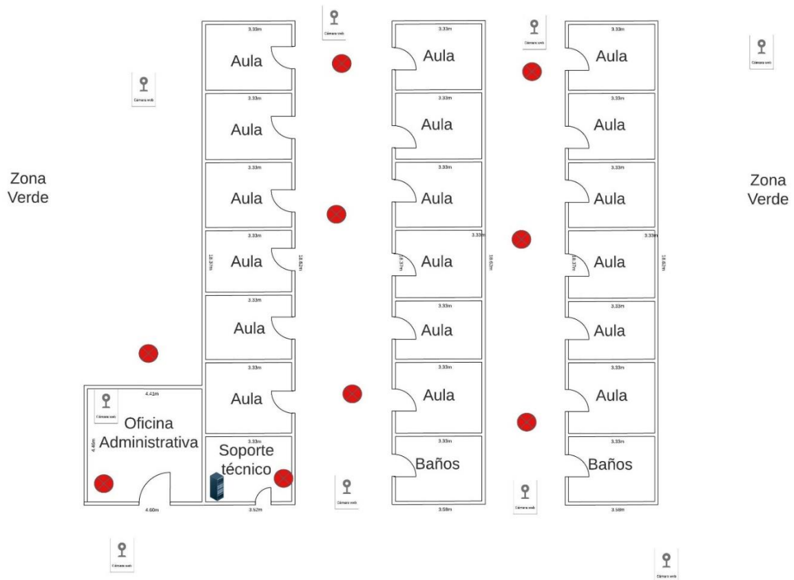
Ilustración 30, Distribución de equipos de María Auxiliadora
