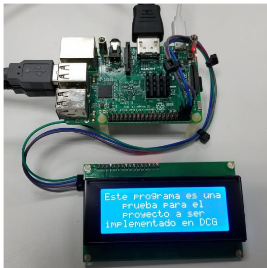
Figura 33. Circuito electrónico de pruebas para el LCD.
