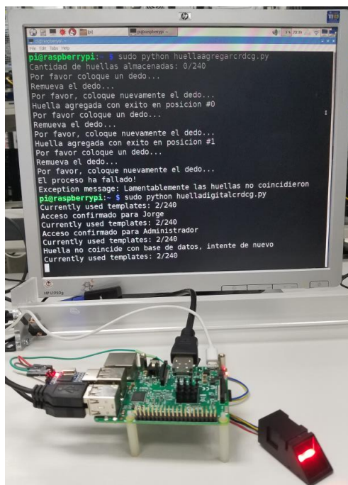
Figura 26. Circuito electrónico de pruebas para el sensor de huella digital.
