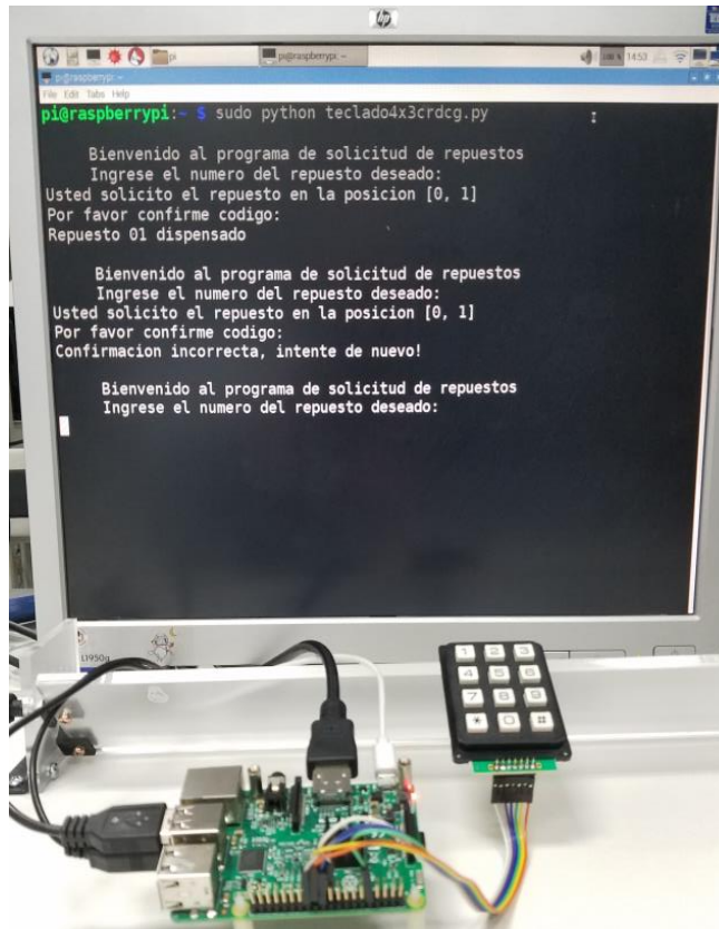
Figura 36. Circuito electrónico de pruebas para el teclado matricial.
