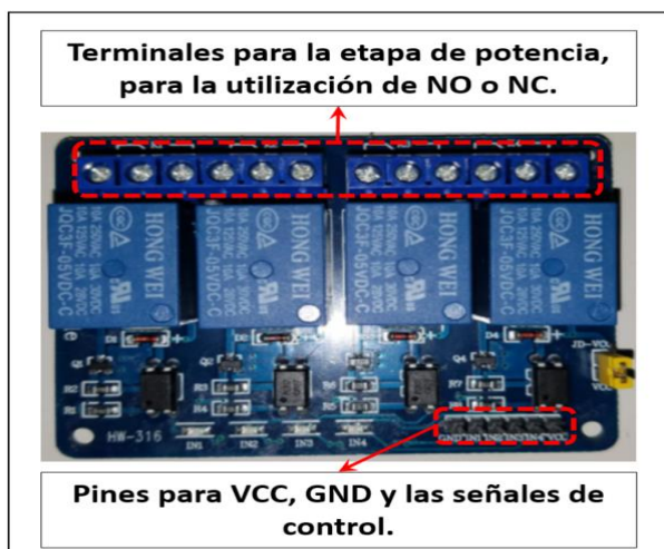
Figura 8. Módulo de relevadores de 4 canales.
