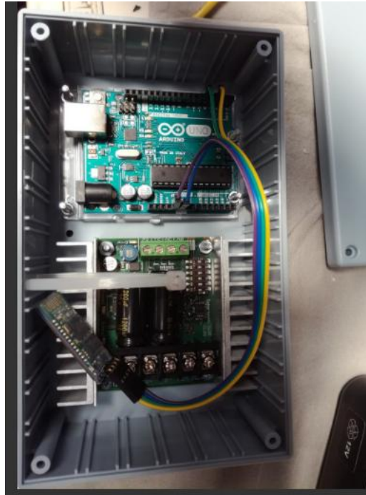
Figura 37 Colocación de componentes en la caja de control
