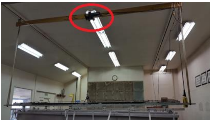
Ilustración 16: Banda transportadora (Mecanismo de Movimiento)– Motor (Movimiento Vertical) – Coopesa
