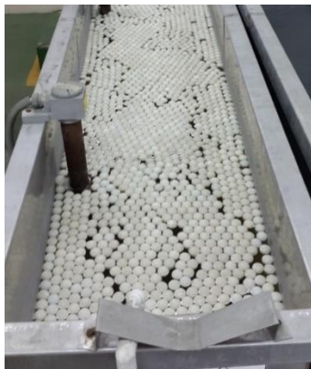
Ilustración 7: Tanque 1 (Limpieza alcalina) – Planta de Anodizado – Coopesa
