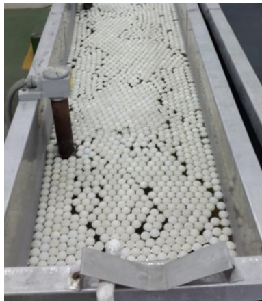
Ilustración 15: Tanque 1 (Limpieza alcalina) – Planta de Anodizado – Coopesa
