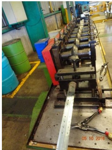
Figura 15. Perfiladora 5, Tren de formado.
