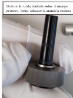
Figura 19: Instalando la nueva rueda dentada
