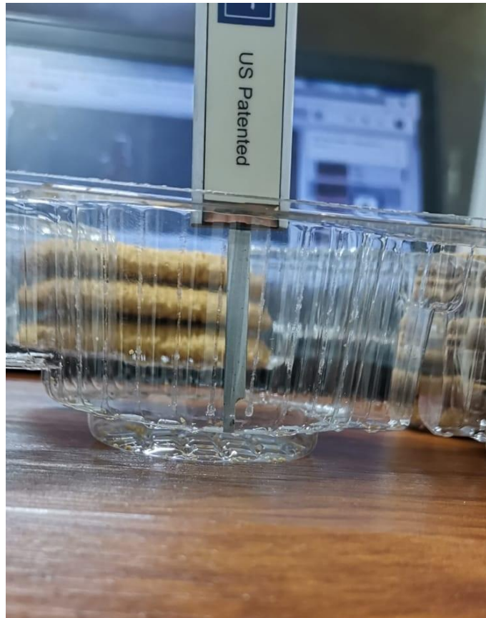
Figura 36. Imagen pruebas en modificación de dimensiones de bandejas PET, imagen facilitada por el proveedor.
