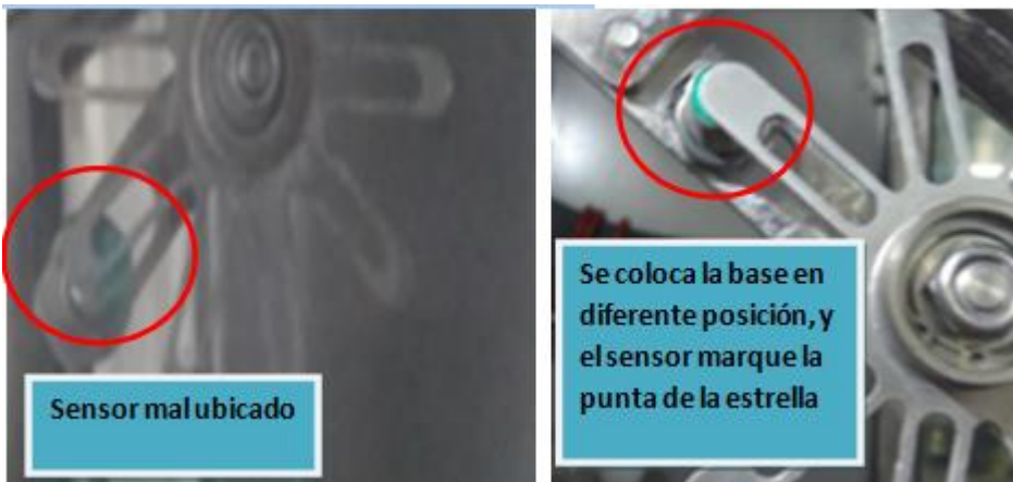
Ilustración 42 Ajuste del sensor de la estrella
