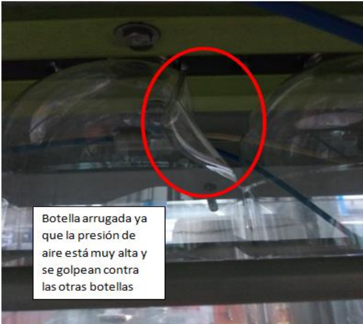
Ilustración 24 Botella arrugada en el transportador aéreo
