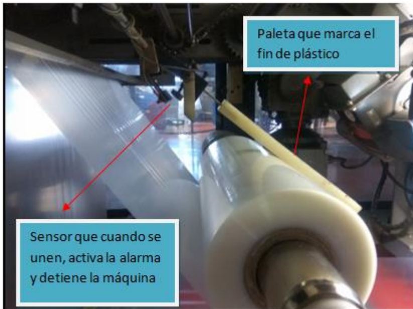
Ilustración 56 Sensor de fin de plástico termo encogible
