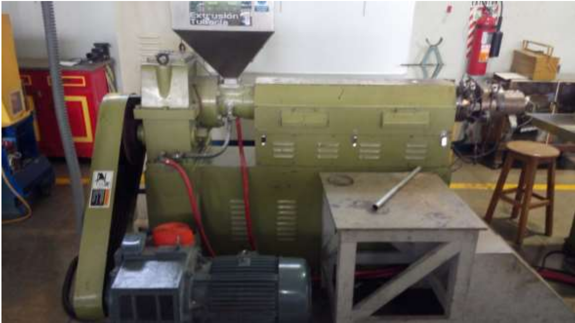
Figura 10. Equipo de Tuberías y Perfiles
