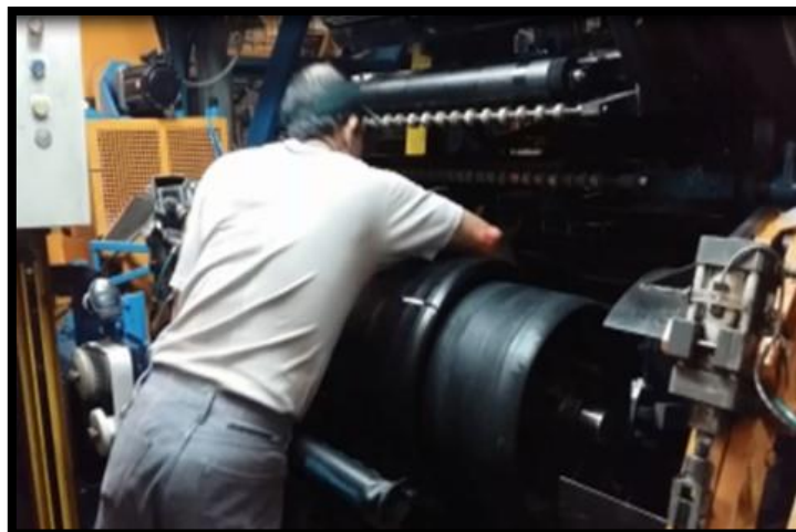
Figura 43: Colocación de número de armador.
