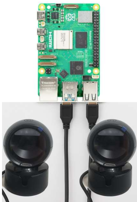
Figura 21 Conexiones del Raspberry Pi con lectores de código de barras
