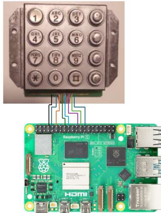
Figura 20 Conexiones del Raspberry Pi con teclado matricial
