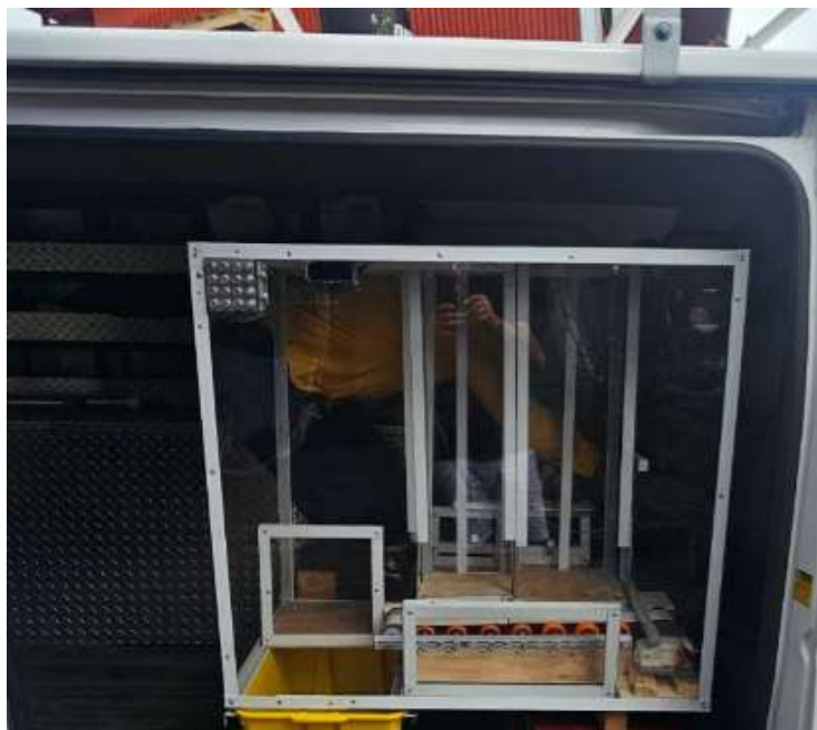
Figura 48 Dispensador instalado en vehículo del ICE
