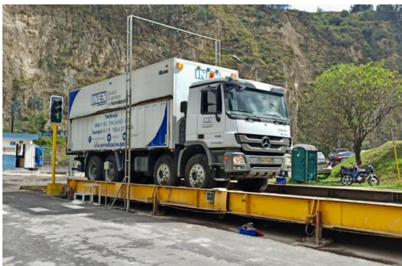
Figura 19 Equipo de pesaje de camiones recolectores de desechos sólidos.
