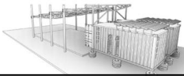
5. ESTRUCTURA DE CERCHAS
