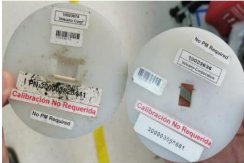
Figura 2 Fixture actualmente utilizado para soldadura de L Flex.
