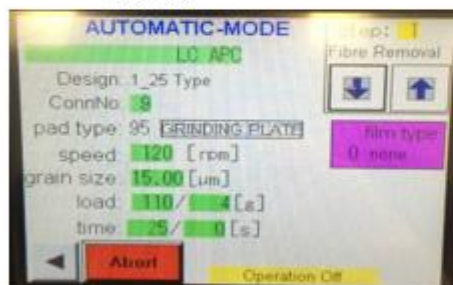
Diagrama A: LC APC Paso 1
