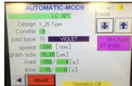
Diagrama D: LC APC Paso 4
