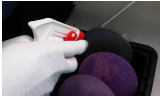
Figura 17: Limpiando la platina de pulido
