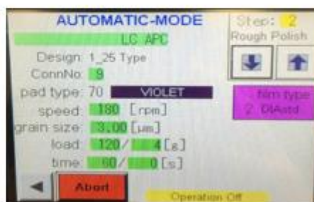
Diagrama B: LC APC Paso 2
