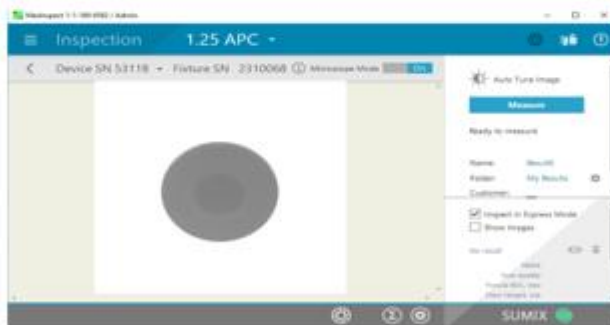
Figura 33: Cara de fibra en buen estado
