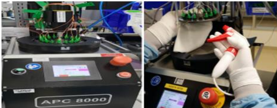
Figura 25: Limpiando la parte de abajo del fixture de pulido
