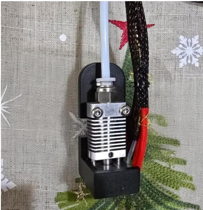
Figura 20. Hotend (cabezal de extrusión) tipo Ender 3 con bloque calefactor, disipador y tubo PTFE
