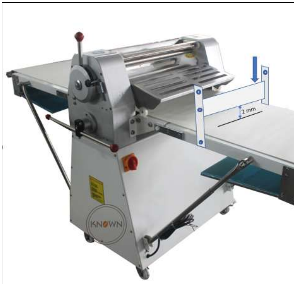
Ilustración 3 Puesta del nivelador a 2mm
