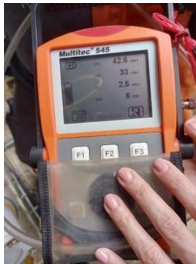
Ilustración 17 Medición de metano en relleno la Carpio
