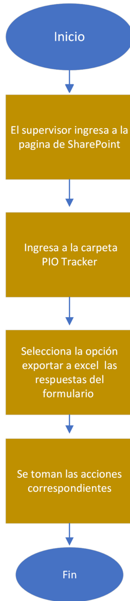
Figura 19 Diagrama del proceso propuesto para la recopilación de retroalimentación
