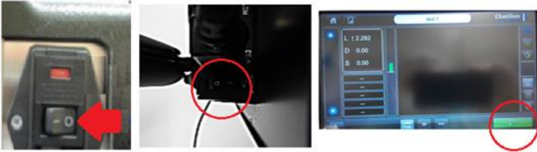
Figura 11 Operación#3: Encendido del equipo y selección de la receta Fuente: Elaboración propia
