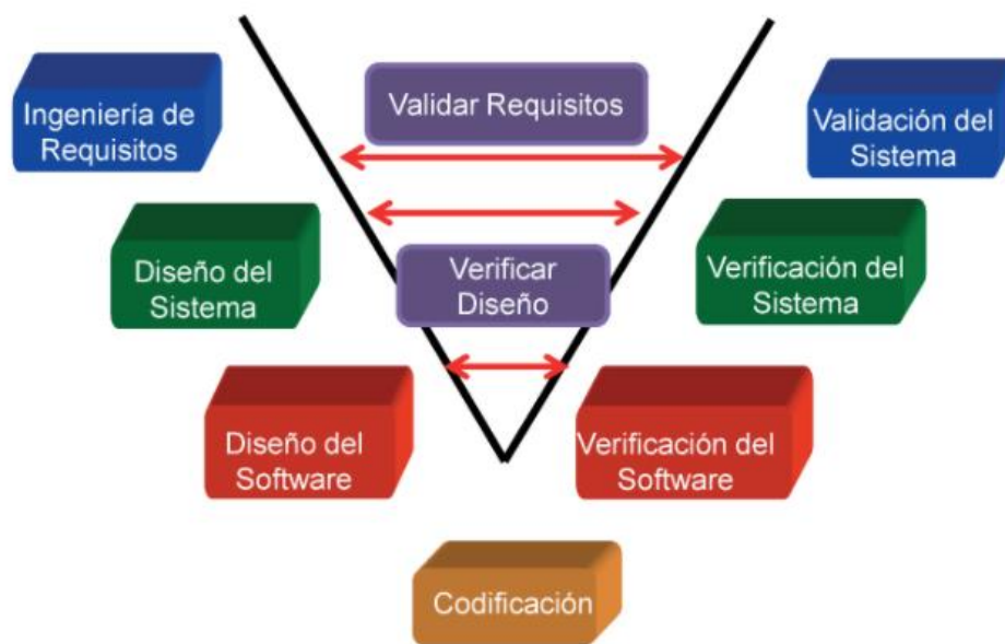
Figura 10 Diagrama de modelo V Fuente: Programación web en el entorno de servidor p.23
