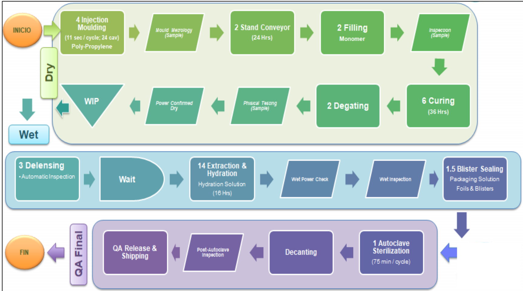
Figura 16. Diagrama de flujo de los procesos de manufactura en CooperVision
