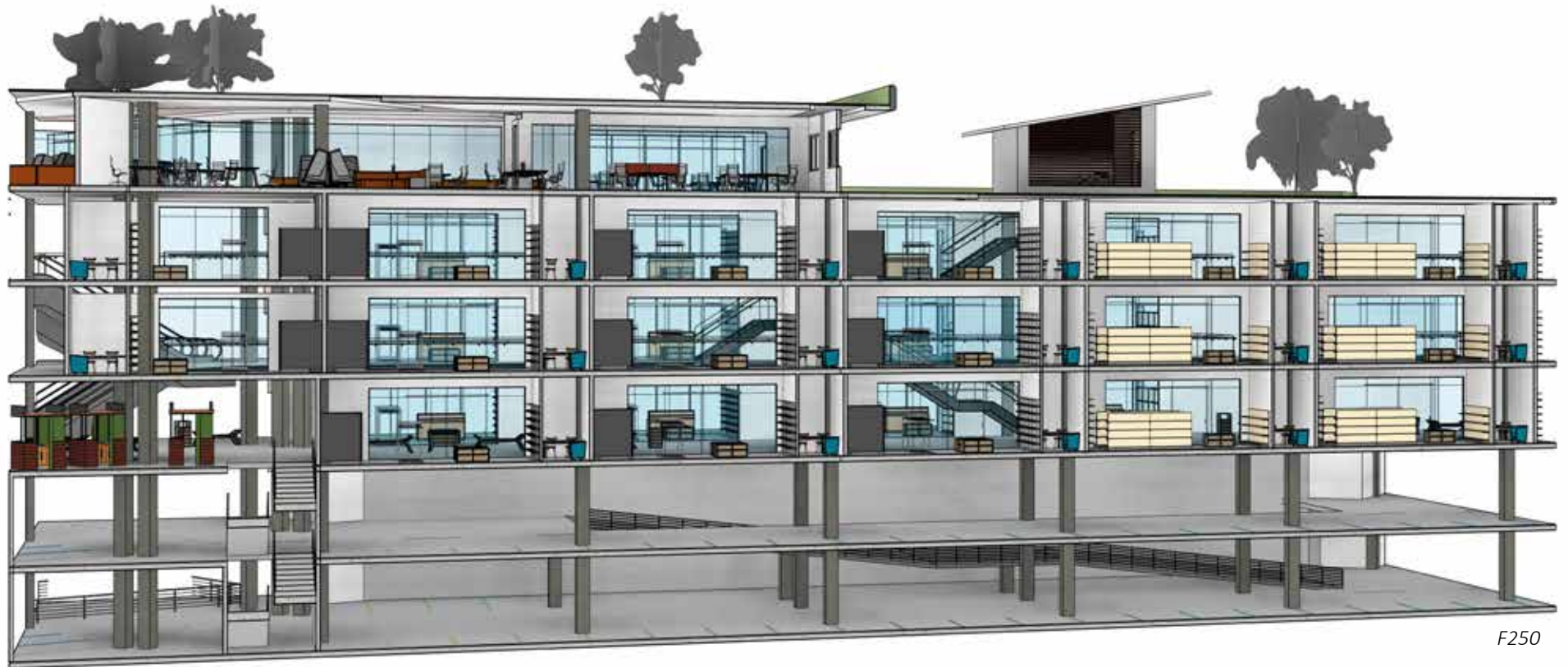
CORTE FUGADO TIENDAS, OFICINAS COWORKING Y SÓTANOS
