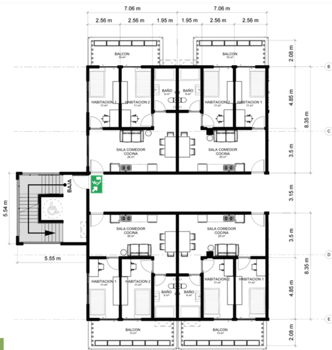
PLANTA ARQUITECTÓNICA APARTAMENTO TIPO 5 ESC: 1 : 50
