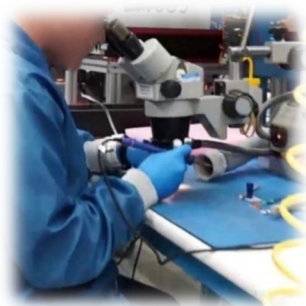
Figura 6 Proceso de inspección de cables.
