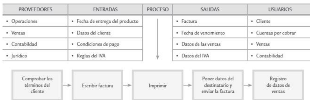
Figura 2. 3 Ejemplo de un diagrama PEPSU para la expedición de una factura
