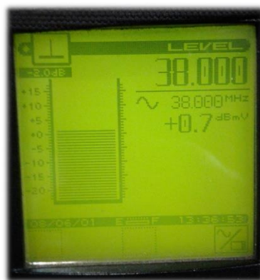
Figura 68: Medición de señal de retorno RF atenuada
