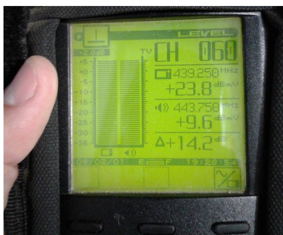
Figura 20: Medición de potencia de audio y video tomados del modulador del canal 60
