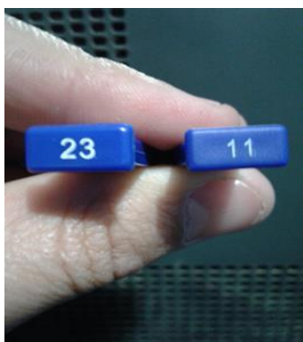
Figura 67: Atenuadores de tipo “pad” para “splitter” MaxNet
