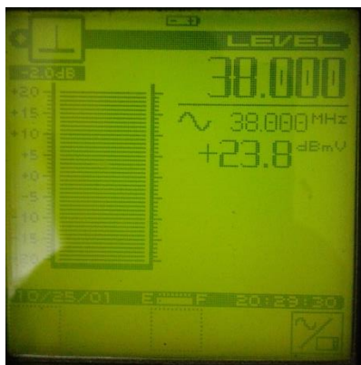
Figura 66: Medición de portadora de llegada en cabecera (38 MHz)
