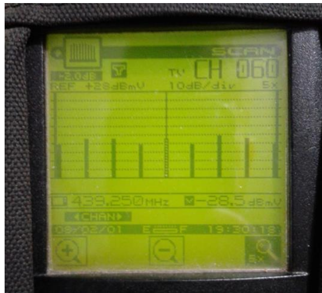
Figura 23: Medición realizada con el medidor de campo en el punto de prueba del combinador
