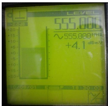
Figura 63: Medición de la portadora “downstream” posterior a la atenuación de 6 dB
