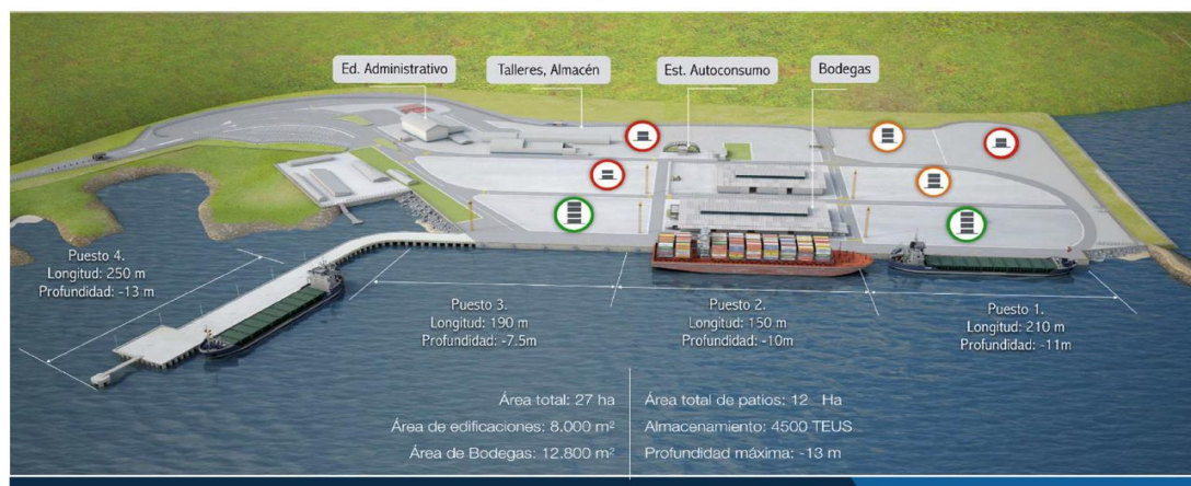
Ilustración N°9: Puestos de atraque con sus respectivas dimensiones.
