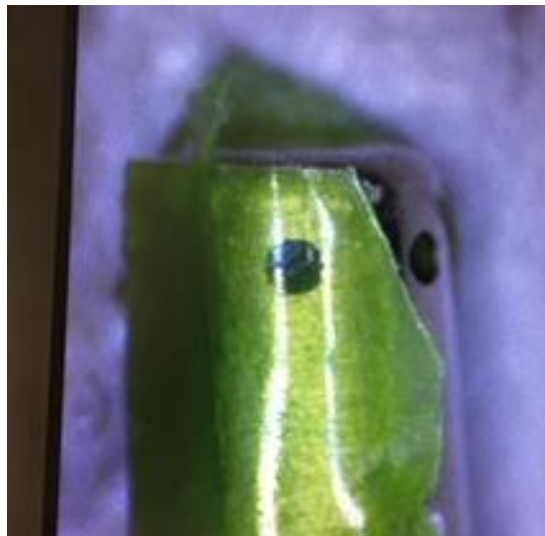
Figura 25. Orificio de irrigación completamente bloqueado
