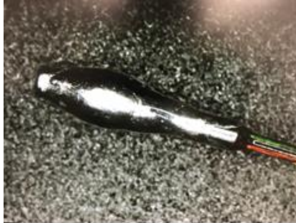
Figura 39. Pre- estañado con dos gotas de flux
