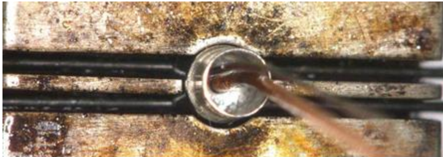
Figura 35. Posición de la parte distal de la termocupla utilizando el accesorio de ayuda.
