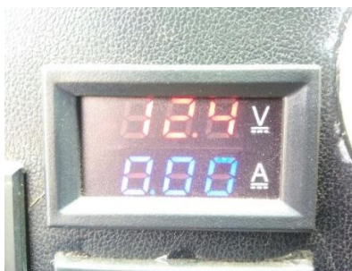
Figura 22 Voltaje de operación en mínimo de RPM y con la celda trabajando
