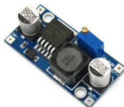
Figura 15 LM2596 convertidor de voltaje de corriente directa a corriente directa
