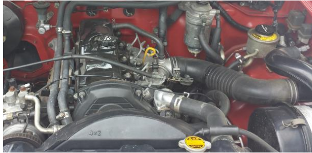
Figura 4 Motor TOYOTA 3L.
