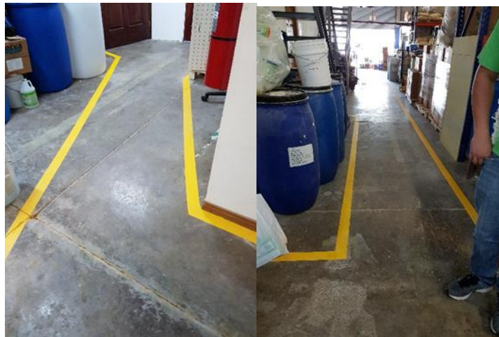
Figura 59 Demarcación del piso de la planta.
