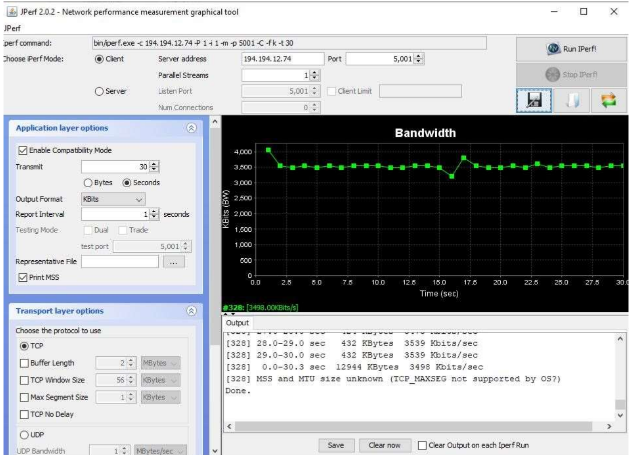
Anexo 5.1. Medición ancho de banda Protocolo TCP Cliente
