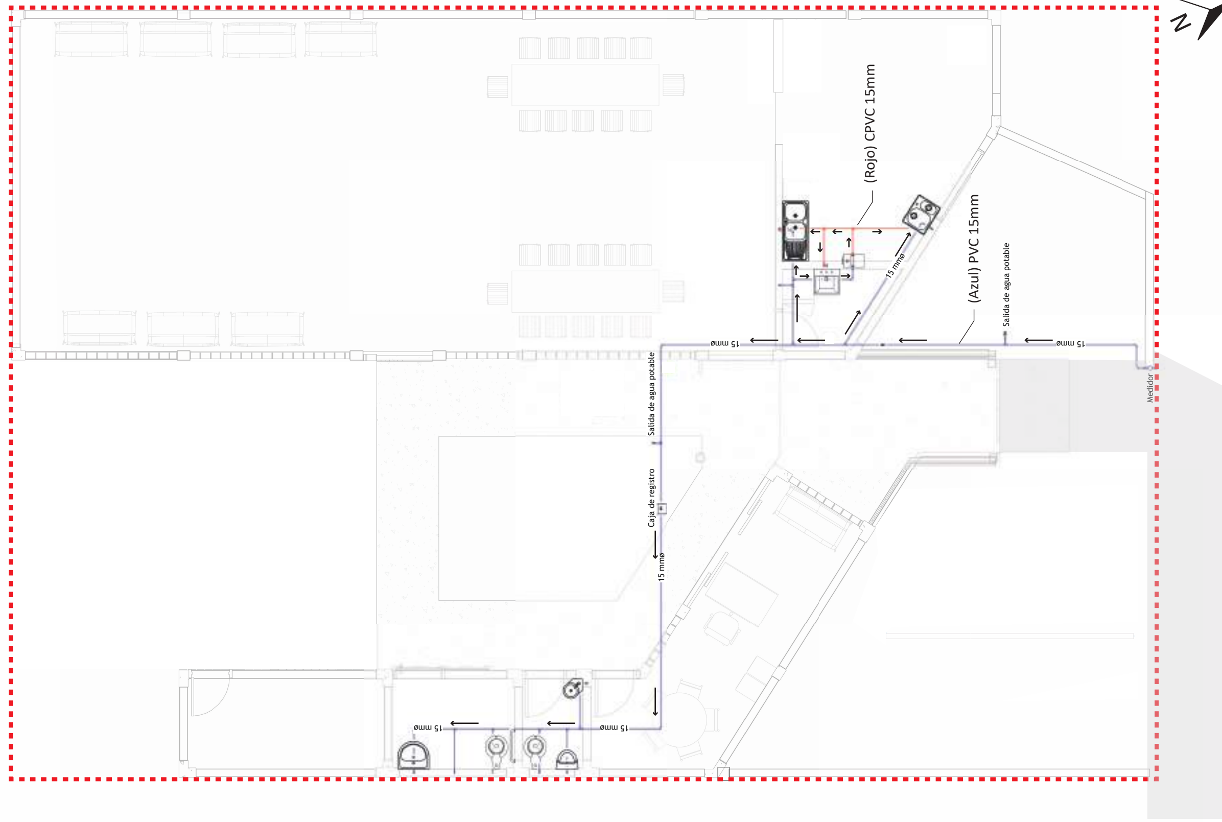
Sistema de agua potable 1:75
