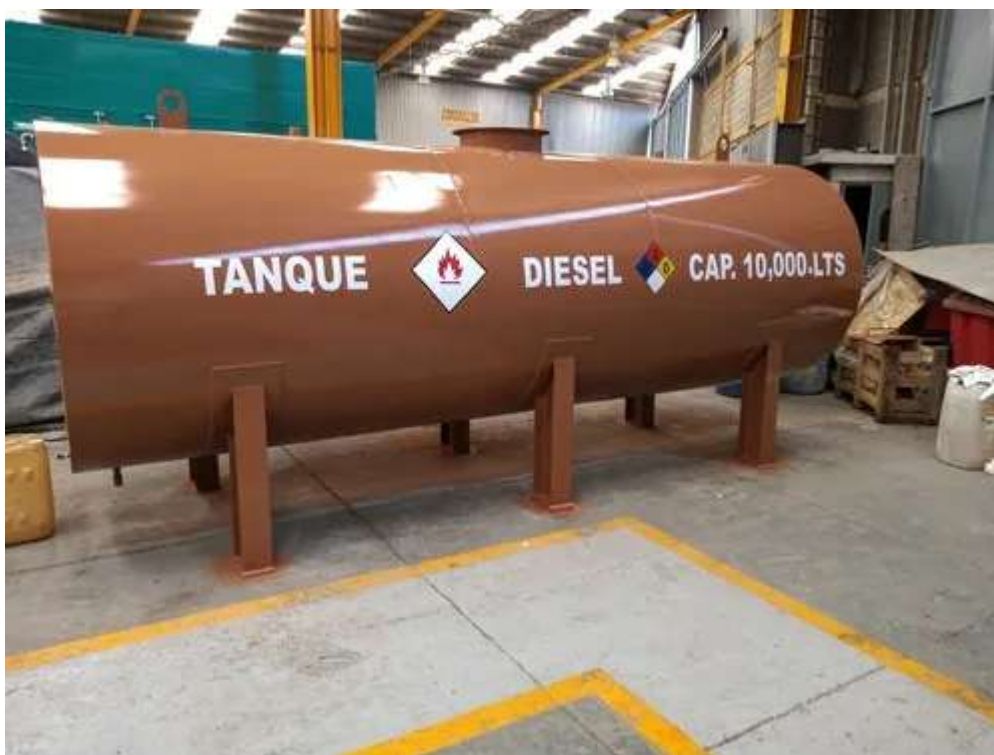
Ilustración 29 Ejemplo de tanque de almacenamiento de 10.000 litros.
