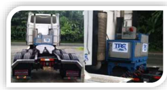
Ilustración 2 Equipo con planta Genset
