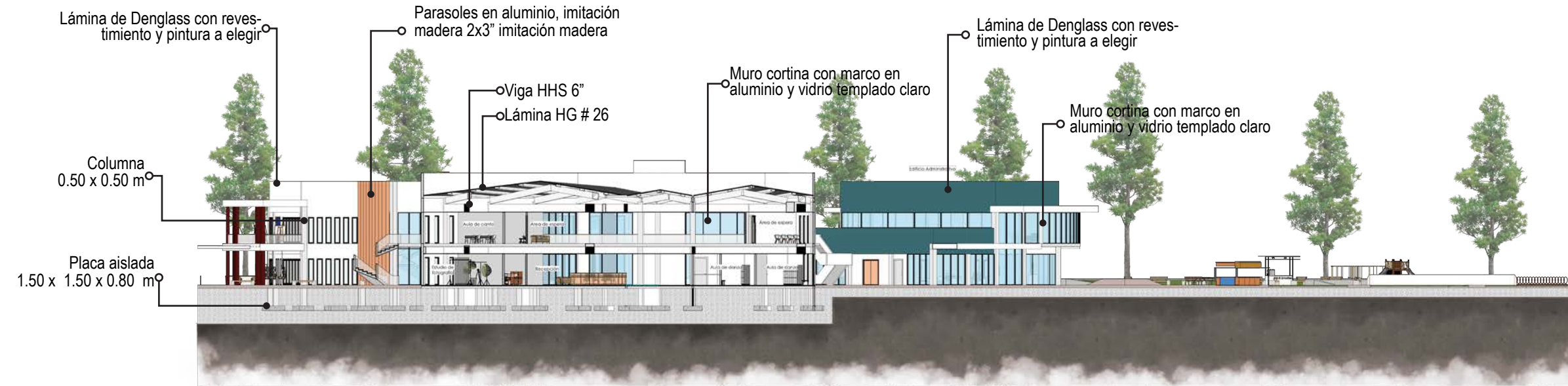
4.13.4 Corte transversal Este - Oeste Escala 1:100
